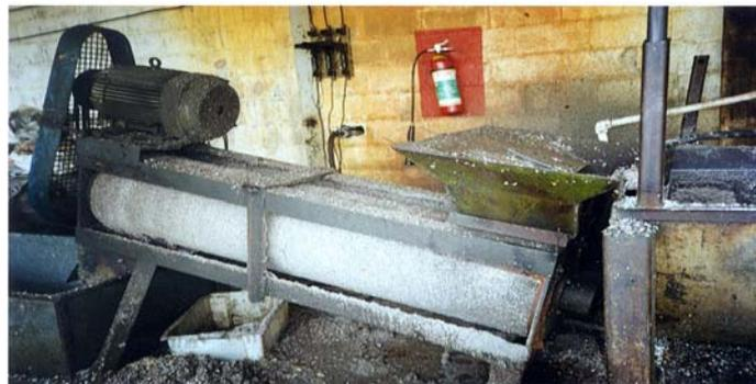
**Figura 15 – Equipamento utilizado para secagem do material moído e lavado.**
