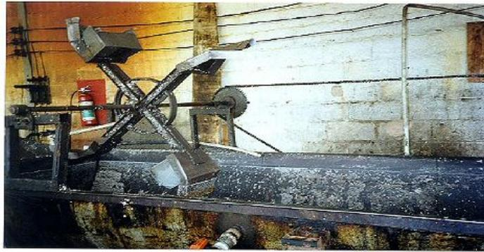
**Figura 14 – Equipamento utilizado para lavagem de fragmentos plásticos.**
