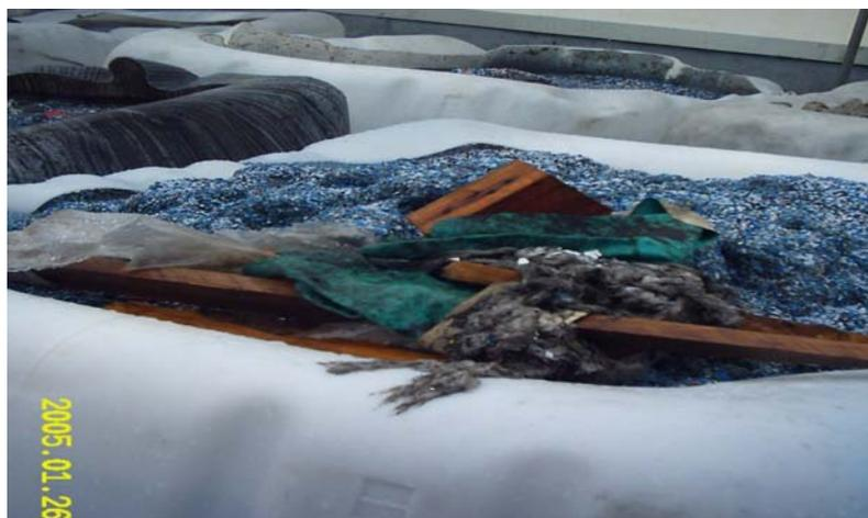
**Figura 41 – Rejeito do Processo de Reciclagem sendo armazenado junto a pedaços de madeira, estopa, plástico filme, entre outros.**
