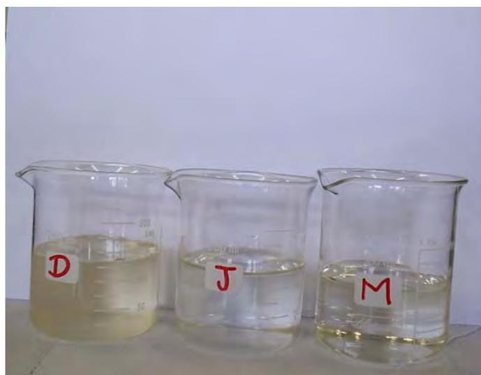
**Figura 5.4: Comparação entre os três tipos de amostra estudadas: D – amostra proveniente do decantador secundário, J – amostra após o Jar Test e M - permeado da ultrafiltração.**
