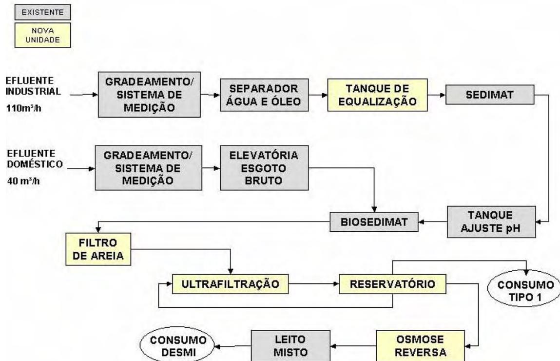
**Figura 2.8: Fluxograma do Processo de Tratamento de Efluentes incluindo Reuso**
