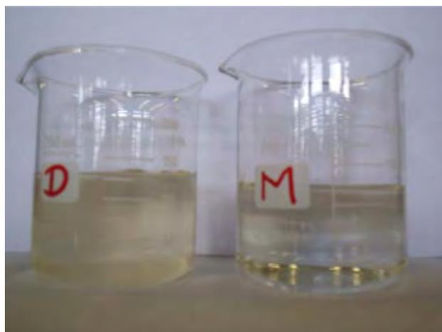
**Figura 5.1: Comparação entre efluente do decantador e permeado da membrana de ultrafiltração**
