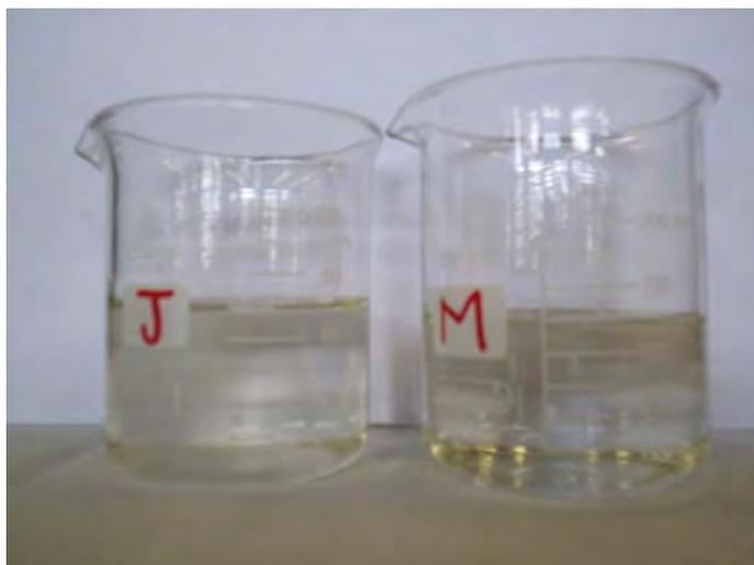
**Figura 5.3: Comparação entre efluente após o Jar Test e permeado da ultrafiltração**
