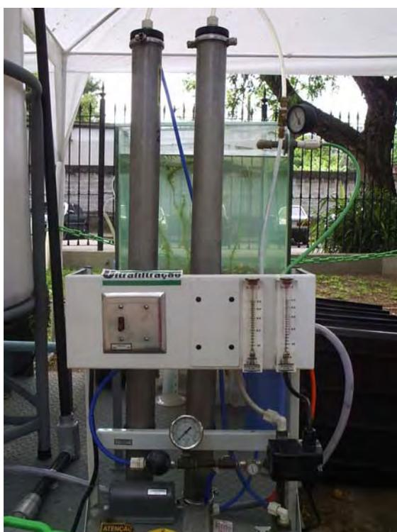
**Figura 2.6: Detalhe do sistema piloto de ultrafiltração**
