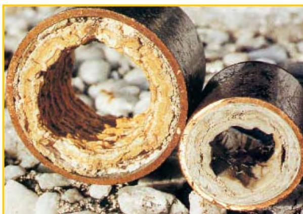
**Figura 2.18: Depósitos de óxido de ferro devido à água contendo bicarbonato de ferro**
