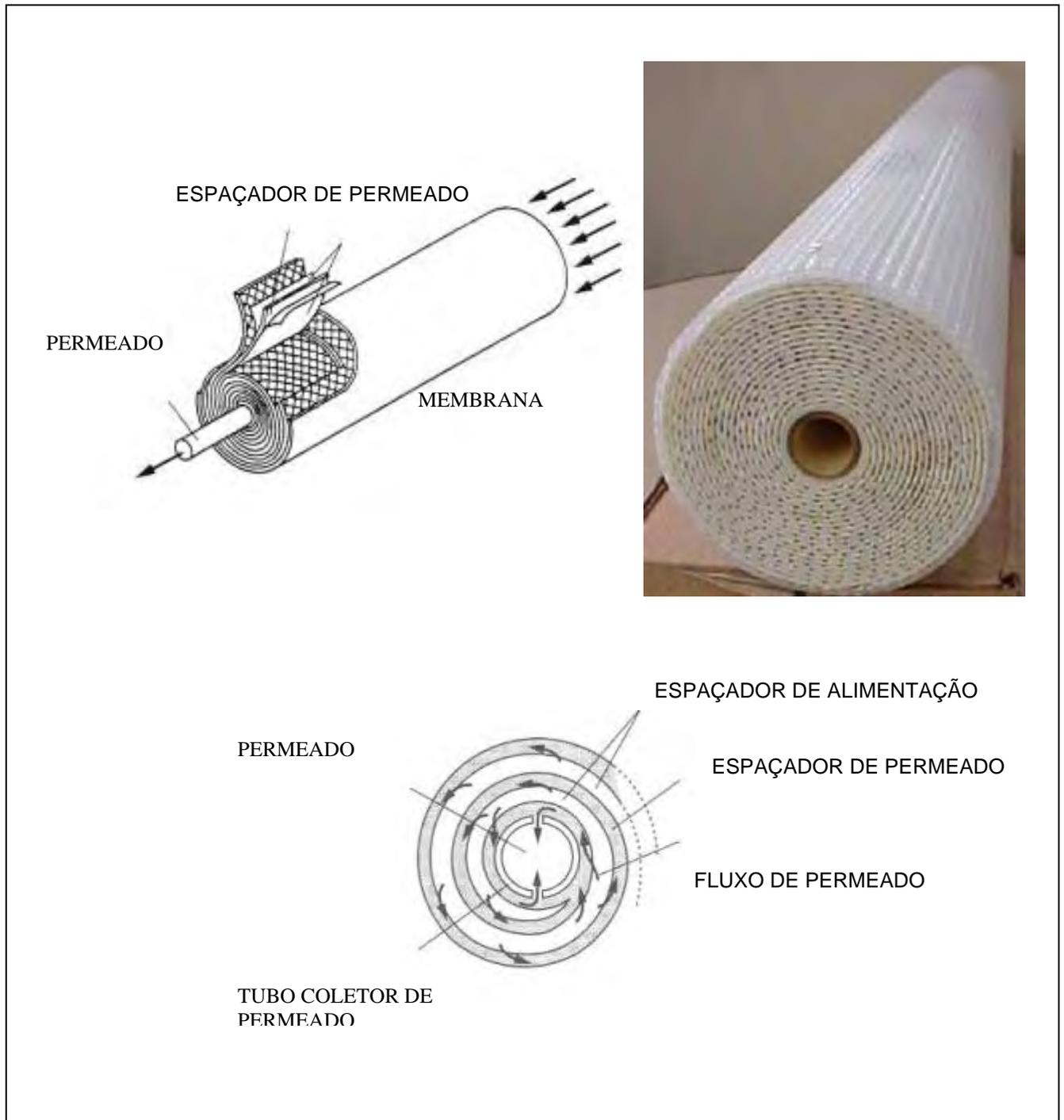
**Figura 3.7: Esquema do Módulo Espiral de Membranas de Ultrafiltração**
