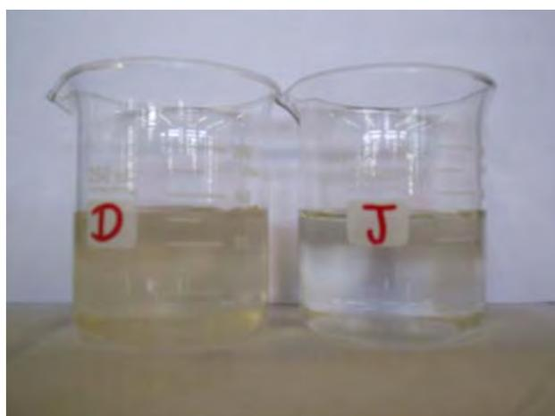
**Figura 5.2: Comparação entre efluente do decantador e efluente após o Jar Test**
