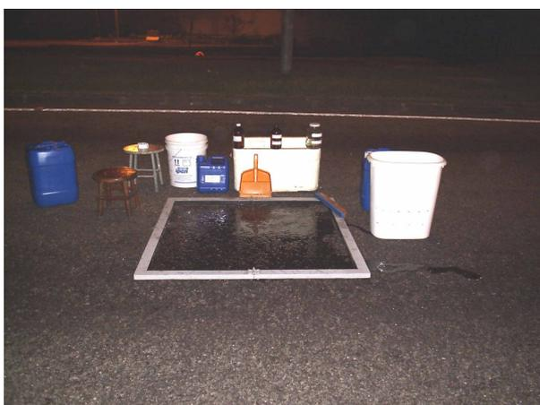
**Figura 5.9. Detalhes da marcação na pavimentação e material utilizado para o recolhimento das amostras.**
