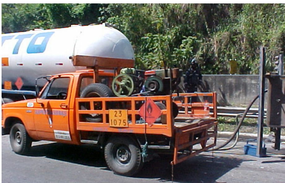
Figura 26: Acidente com gás liquefeito de petróleo (GLP) - Procedimentos de transbordo da carga (Fonte e autoria: FEEMA/SCPA - Carlos Eduardo Strauch.)
