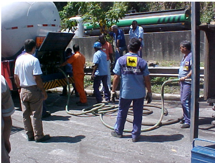
Figura 25: Acidente com gás liquefeito de petróleo (GLP) - Procedimentos de transferência / Transbordo da carga, para permitir o destombamento da carreta. (Fonte e autoria: FEEMA/SCPA - Carlos Eduardo Strauch.)
