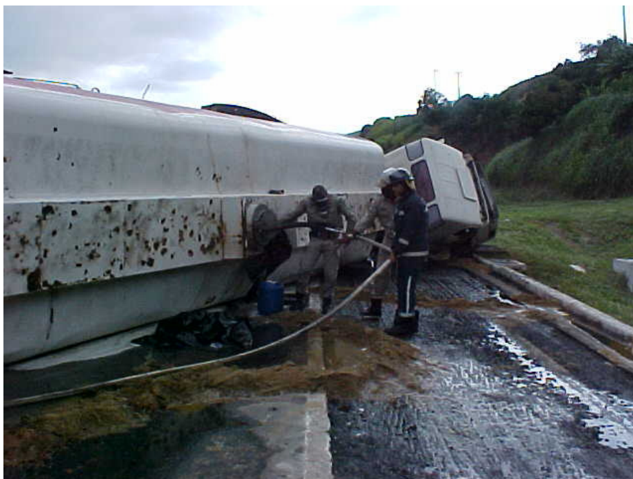
Figura 4: Acidente com álcool anidro - Procedimento de degaseificação do tanque, para o destombamento. (Fonte e Autoria: FEEMA / SCPA – Alberto Andrade Cruz).
