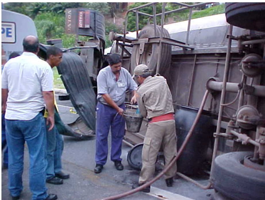
Figura 3: Acidente com álcool anidro - Transbordo do produto restante no tanque, pela válvula de fundo. (Fonte e Autoria: FEEMA / SCPA – Alberto Andrade Cruz)
