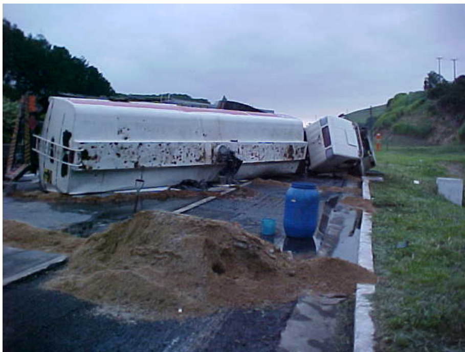
Figura 1: Acidente com álcool anidro – Vista da carreta tombada lateralmente, e diques de contenção. (Fonte e Autoria: FEEMA / SCPA – Alberto Andrade Cruz)
