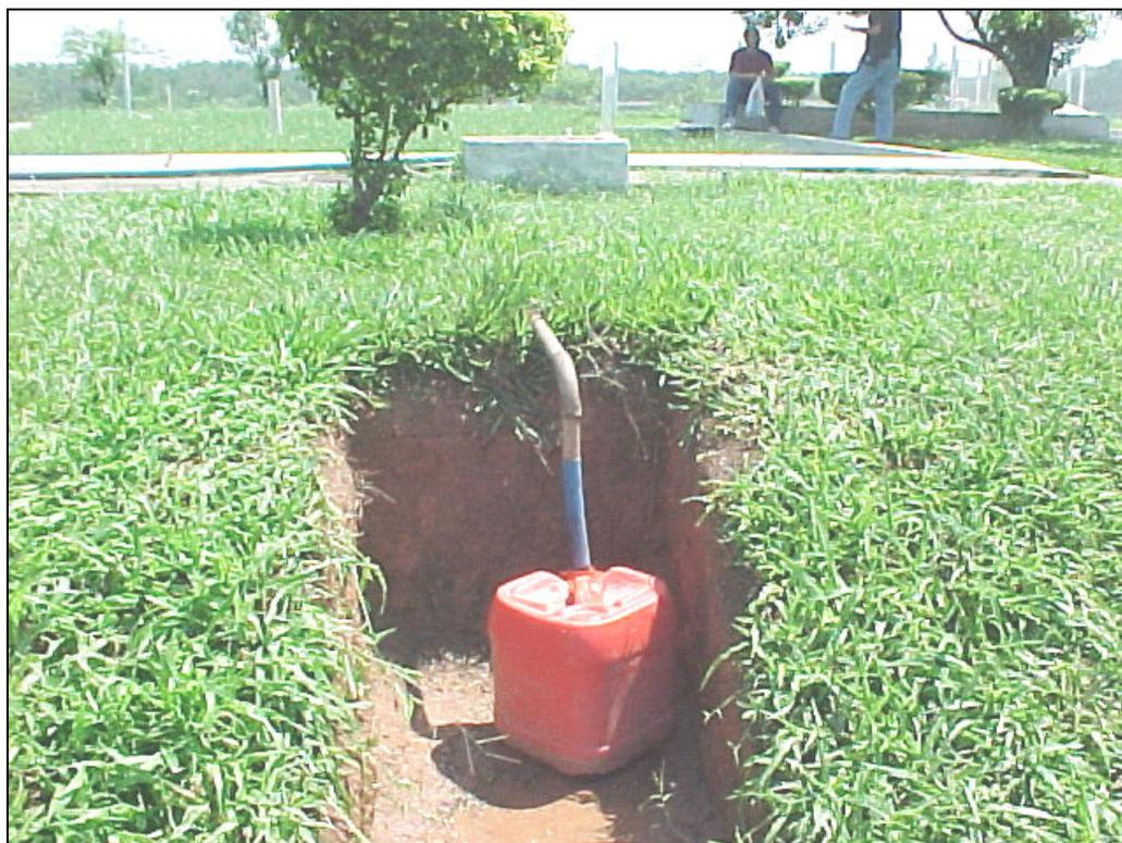
**Figura 3.15 – Aferição de vazão utilizando bombona**
