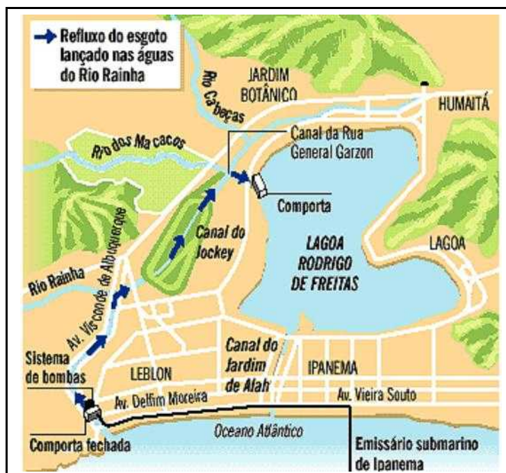
Figura 52. Esquema das estruturas de esgotamento da Lagoa Rodrigo de Freitas (Jornal O Globo, 2002).
