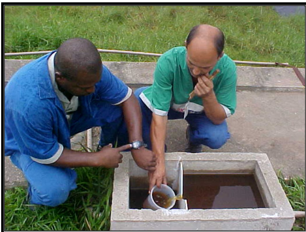
Foto 37 Medição da vazão do chorume.
