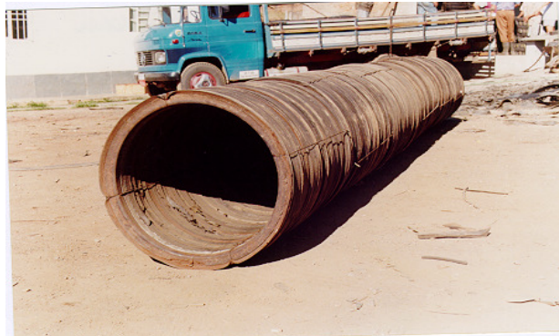
Figura 8 – Tubulação feita de pneus Fonte – Michelin (2000)
